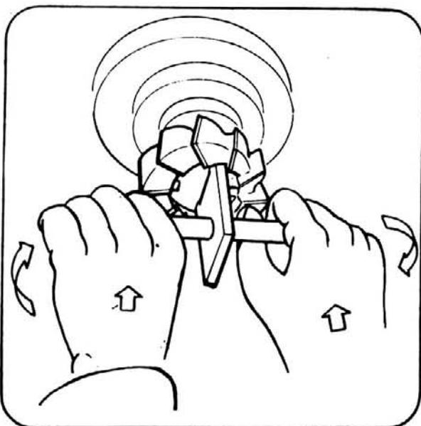
تا آنجاییکه پیچ با دست پیچیده میشود پیچانده سپس بوسیله آچار مخصوص پیچ را کاملاً محکم کنید.
