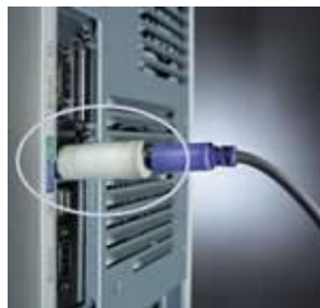
نمونه‌ای از Keylogger سخت‌افزاری
