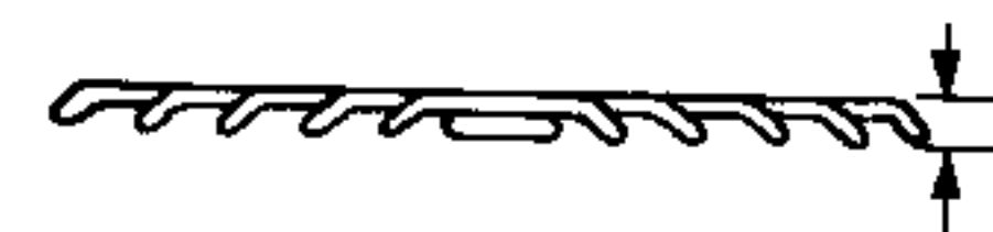
نمای انتهایی ناحیه خم ۱۸۰° که نشان می‌دهد ضخامت، یا ارتفاع کلی، در اینجا کمتر از ۲/۵ سانتیمتر است.
