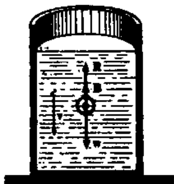
شکل ۹-۵ نیروهای مؤثر بر گلوله کوچکی که درون سیال ویسکوزی در حرکت است.
