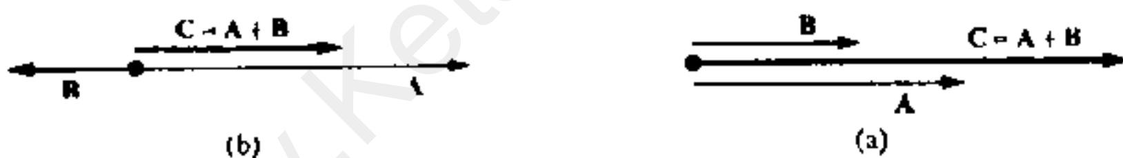
شکل ۷-۱ جمع برداری (a) دو بردار موازی و هم‌جهت (b) دو بردار موازی و غیر هم‌جهت
