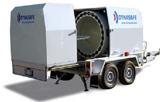
شکل (۱-۸) - یک سد انفجاری متحرک.
