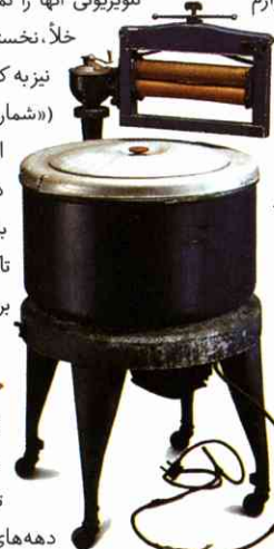
ماشین لباس‌شویی این ابزار که متعلق به ۱۹۲۹ است، برای زیرورو کردن لباس‌ها در گردونه، از موتور برقی استفاده می‌کند. ماشین‌هایی نظیر این به شدت از مشقت‌خانه‌داری کاستند.
