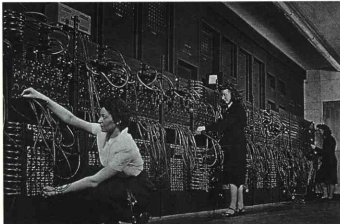
نخستین کامپیوتر تکنیسین‌های بی‌شماری روی این‌یاک، اولین کامپیوتر تمام‌الکترونیکی جهان، کار کردند. همه‌ی ۱۸ هزار لامپ خلأ و محفظه‌هایش، یک اتاق کامل را اشغال می‌کرد.
